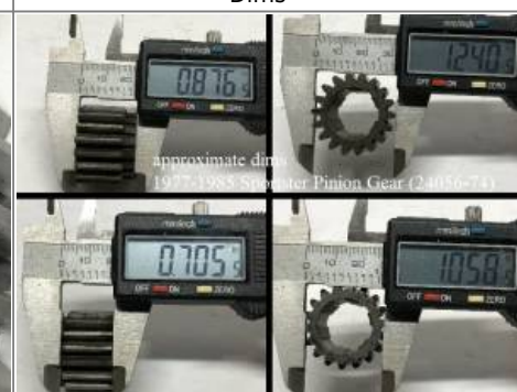
1977-1985 Pinion Gear (24056-74) App. Dims 22)
